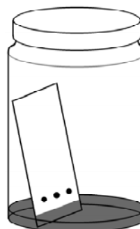
Rys. 1.2 Płytkę TLC umieszczona w komorze chromatograficznej.
