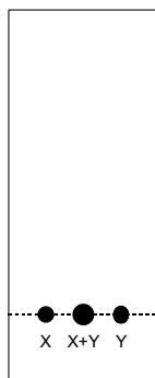
Rys. 1.1 Plamki na płytce TLC przed rozwinięciem; X: 1,4-DHP, Y: Mieszanina reakcyjna.
